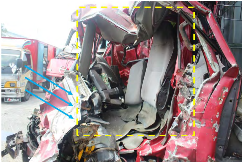
Gambar Rajah 22: Kesan Intrusi pada Bahagian Atas Struktur Kabin Pemandu
