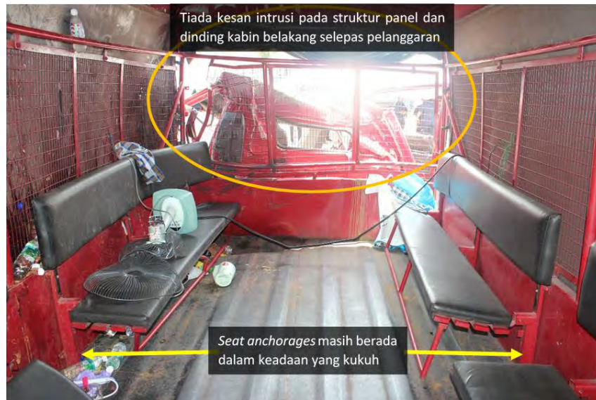
Gambar Rajah 23: Gambaran Seat Anchorages dan Struktur Dinding Kabin Belakang Lori FRU
