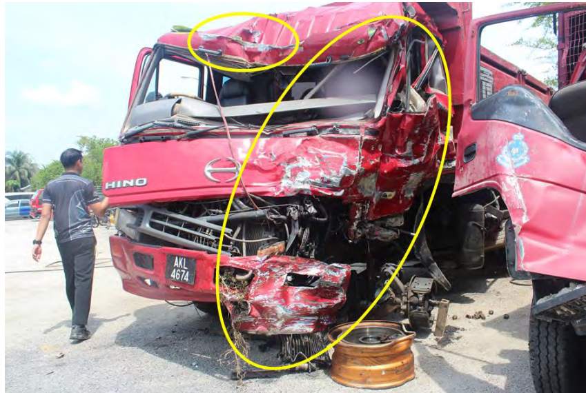
Gambar Rajah 19: Kerosakan Yang Teruk pada Bahagian Hadapan Kiri dan Bumbung Lori Tipper
