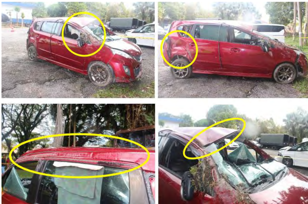
Gambar Rajah 29. Kerosakan pada Perodua Alza yang Disebabkan oleh Kejadian Terbalik ( Roll-over )
