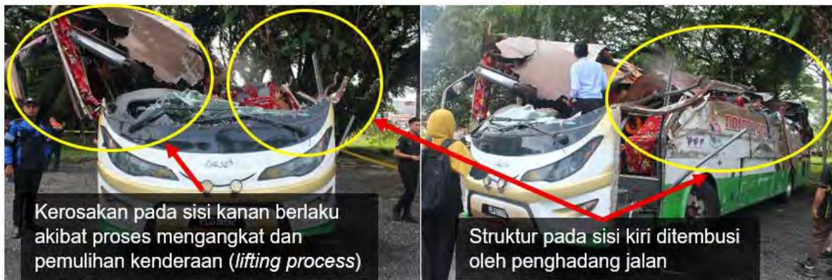
Gambar Rajah 21. Kerosakan Struktur Sisi Kiri dan Kanan Bas
