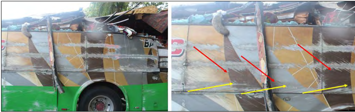
Gambar Rajah 25. Kesan seretan dijumpai pada bahagian kiri badan bas yang menunjukkan dua arah pergerakan yang berbeza.
