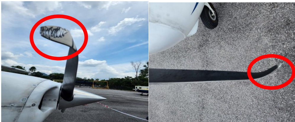
Figure 2: Blade tips bend inward
